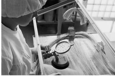
Рис. 9 . Кетгут — первый промышленно изготовленный стерильный рассасывающийся шовный материал из бараньих кишок [1]
